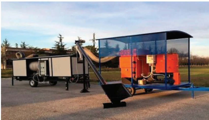
Obrázok 1: Prototyp rotačnej sušičky (Del Guidice a kol. 2019), napojený na zdroj tepla s výkonom 80 kW
